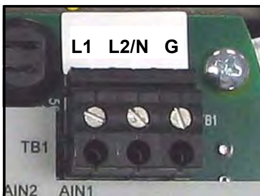
Figure 15: Raccordement sur l'alimentation secteur CA
