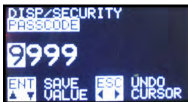
Figure 34: Fenêtre de contrôle de sécurité
