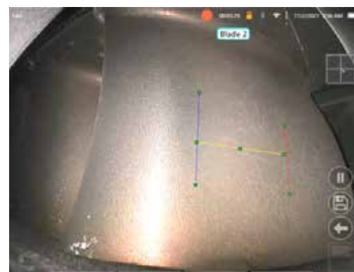
Рис 9с. Активный счетчик лезвий, показывающий исходную область отслеживания
