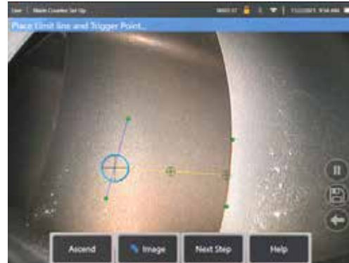
Рис. 3б. Настройка предельной линии между линиями входа и выхода
