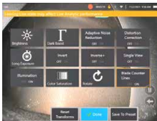
Рис 9б. Подменю 'Изображение' с новой плиткой 'Линии счетчика лезвий'.
