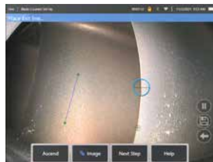
Рис 2b. Отрегулируйте линию выхода на край аэродинамического профиля
