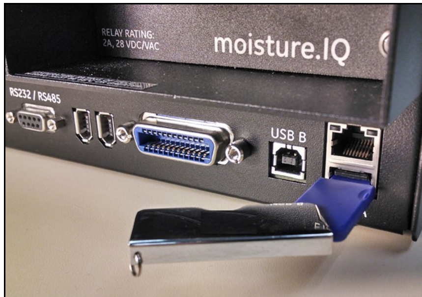
Figura 84: Unidad USB de memoria flash conectada a la parte trasera del chasis
