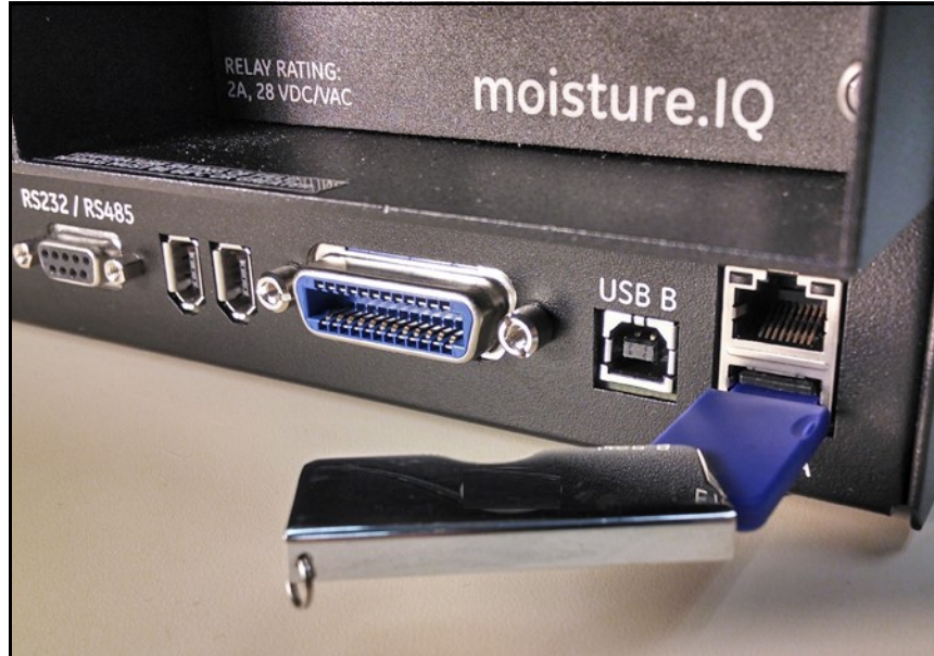
Figura 91: Unidad USB de memoria flash conectada a la parte trasera del chasis
