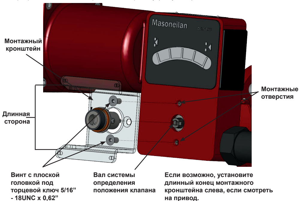
Рисунок 9 - Монтажный кронштейн для установки на привод поворотного клапана
