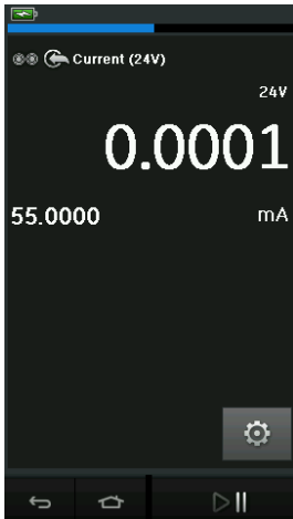
Afbeelding 2-19: Stroom op CH1 meten. Bereik \pm 55 mA
