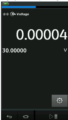
Afbeelding 2-20: VDC of mVDC op CH1 meten
