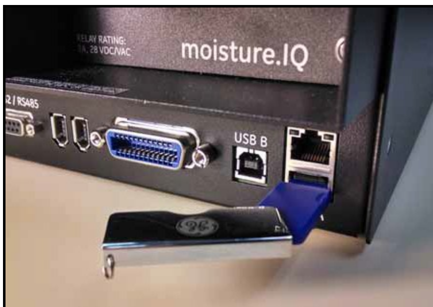
図84：シャーシの背面に差し込まれたUSBメモリ
