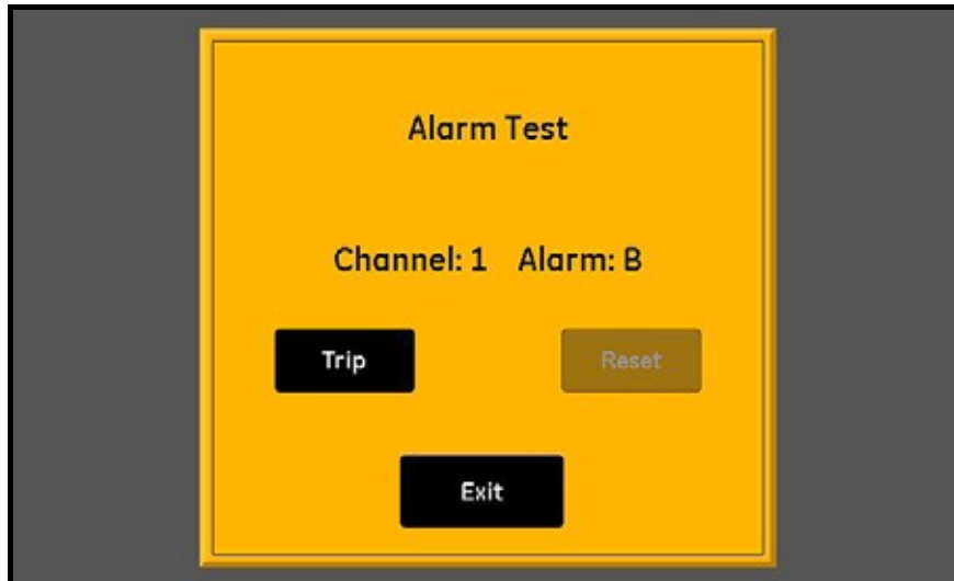
図48 : アラーム試験 (Alarm Test) 画面
