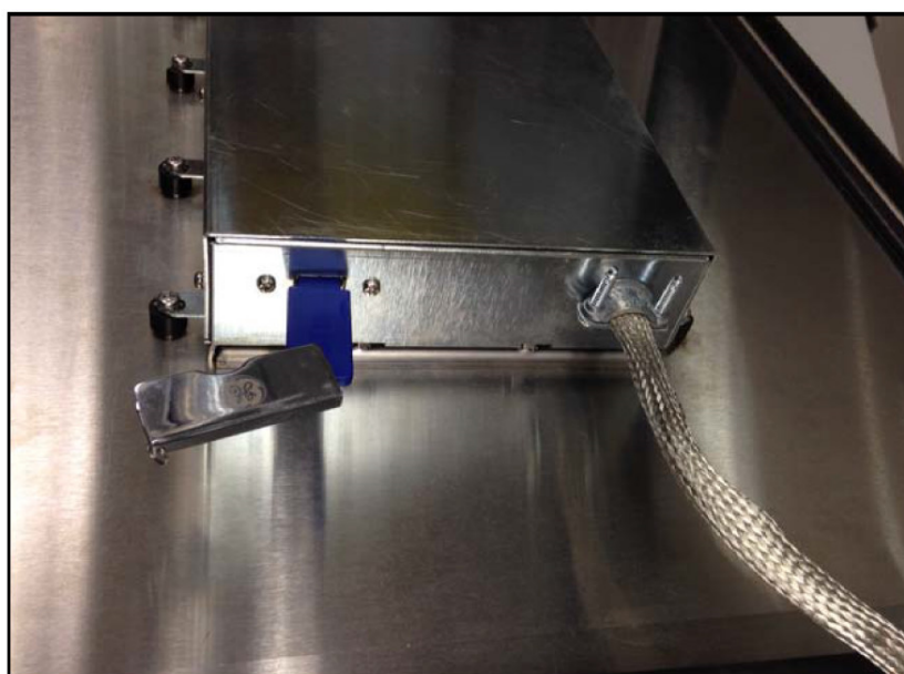
図85：ドア内側のシャーシに差し込まれたUSBメモリ
