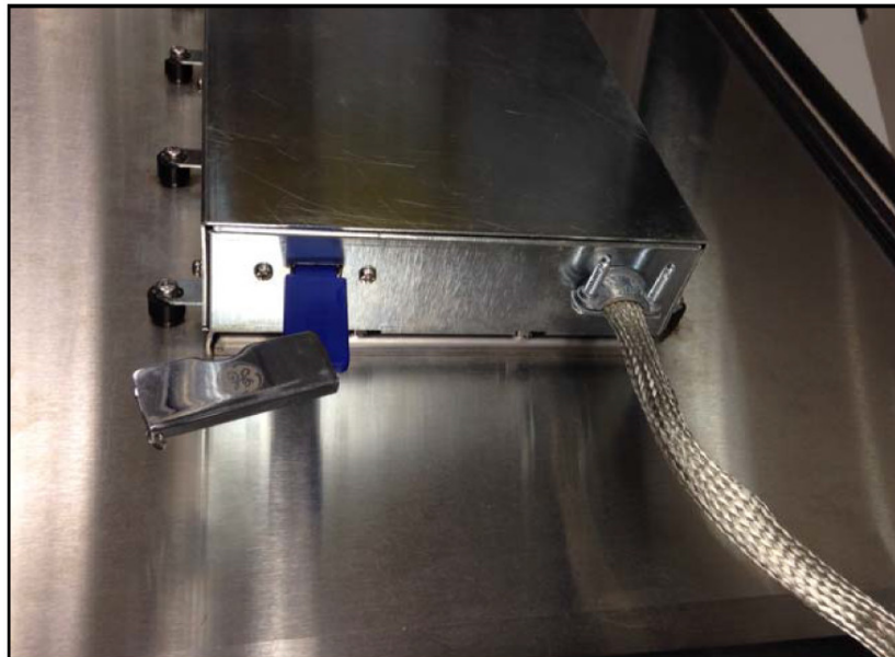
図92：ドア内側のシャーシに差し込まれたUSBメモリ
