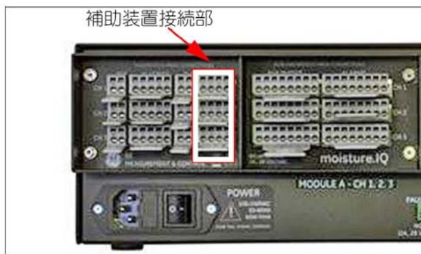
図23：補助装置接続部
