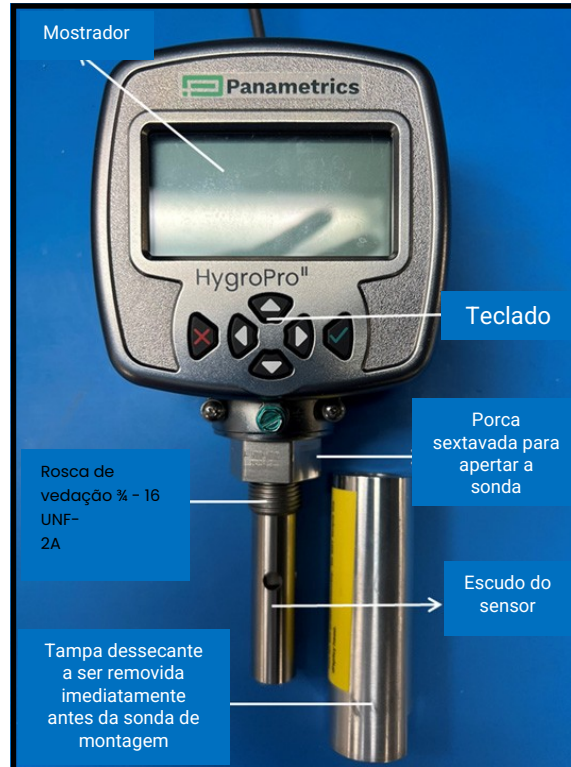
Figura 3: Partes Chave do HygroPro II para instalação
