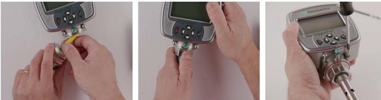
**Figura 19: Reinstalando a sonda Hygro<sup>II</sup> RTE em um transmissor desmontado**
