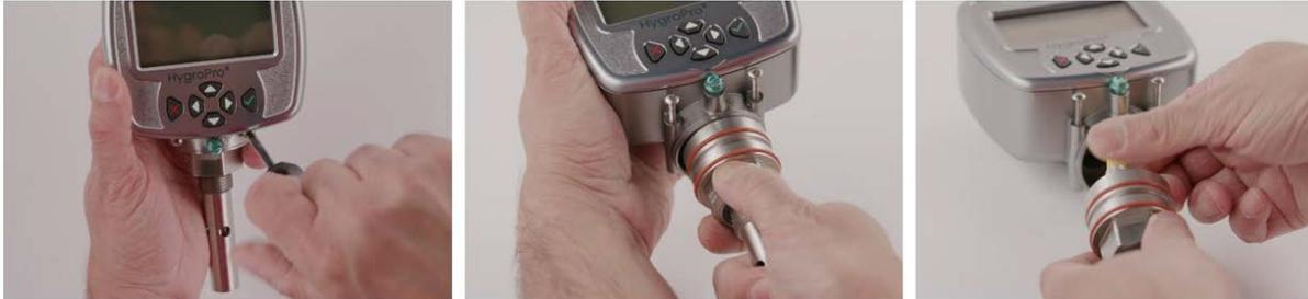
Figura 17: Remoção passo a passo da sonda Hygro<sup>II</sup> RTE do transmissor
