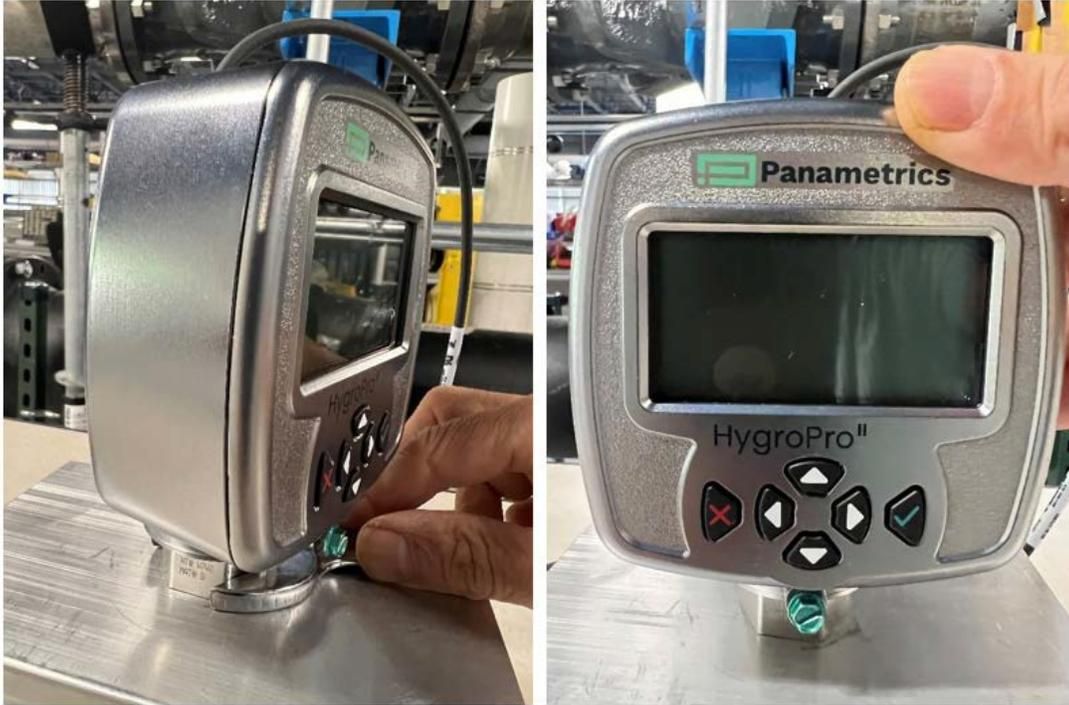
Figura 6: Etapa 3 da instalação do HygroPro<sup>II</sup> – instalação na célula de amostra
