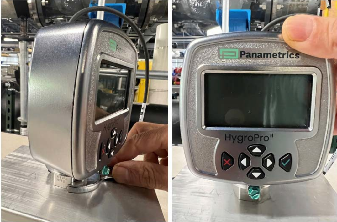
Figura 6: Etapa 3 da instalação do HygroPro II – instalação na célula de amostra
