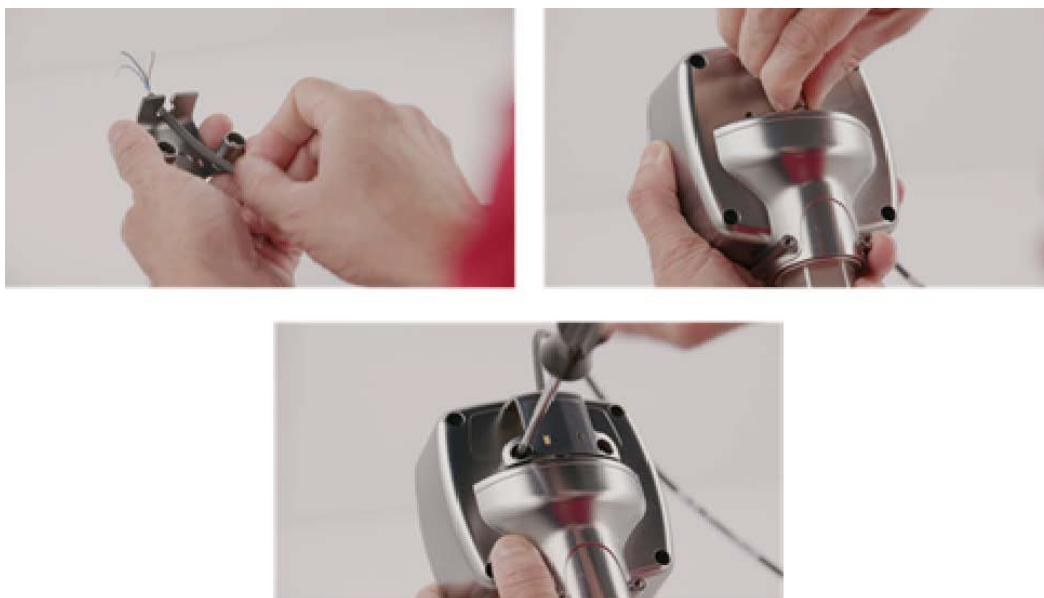
Figura 4: Passo 1 da instalação do HygroProII – fiação inicial
