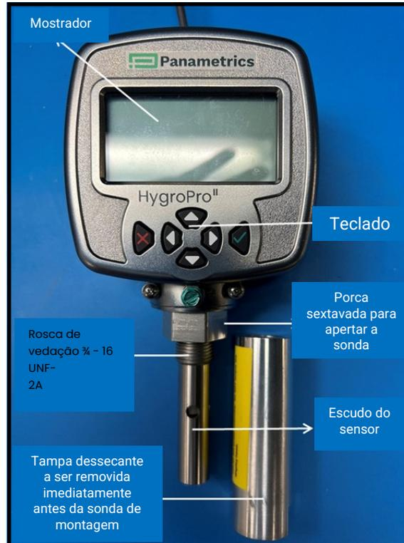
**Figura 3: Partes Chave do HygroPro<sup>II</sup> para instalação**
