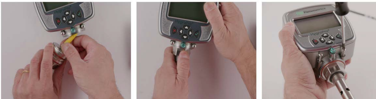
Figura 19: Reinstalando a sonda Hygro II RTE em um transmissor desmontado
