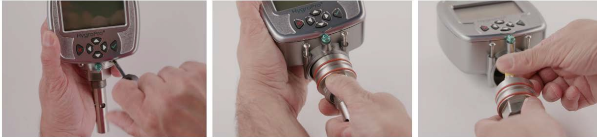
Figura 17: Remoção passo a passo da sonda Hygro II RTE do transmissor
