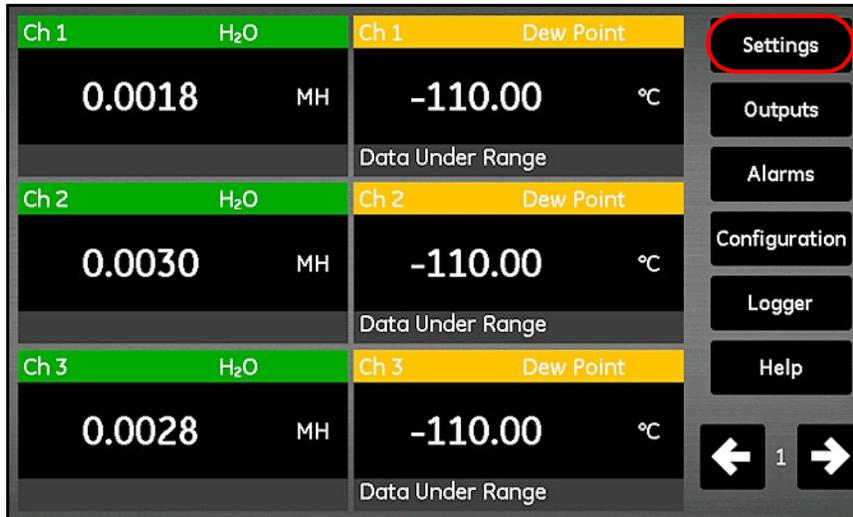
Рис. 86: Кнопка Settings (Параметры) на главном экране
