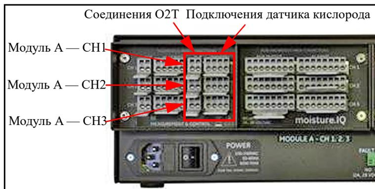
Рис. 18: Подключения датчика кислорода Delta F
