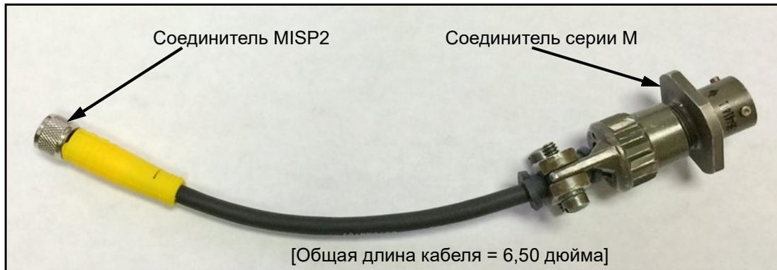
Рис. 6: Кабель преобразователя M-MISP2
