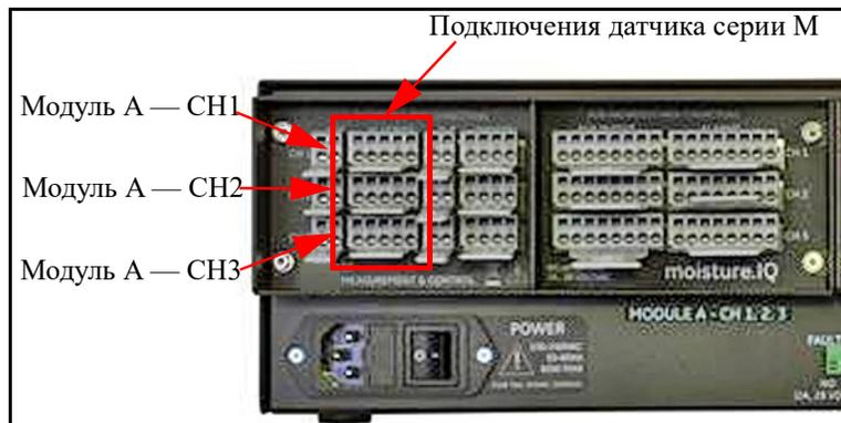
Рис. 13: Подключения датчика серии М
