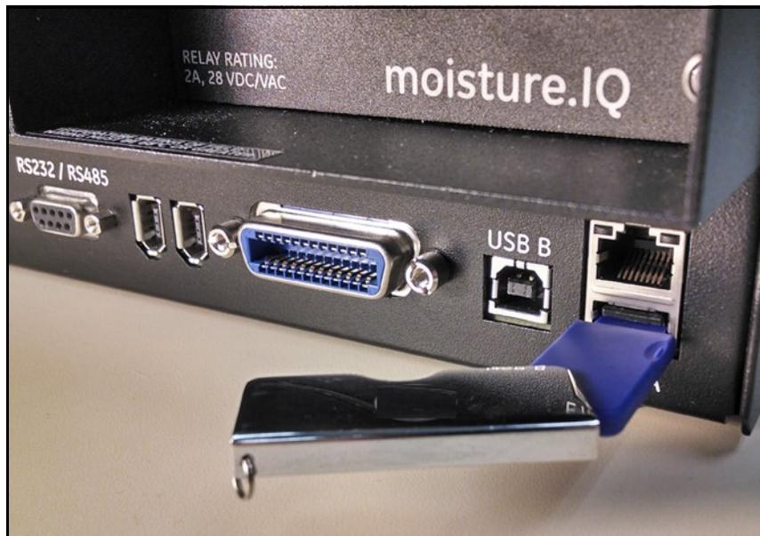
Рис. 91: Подключение флеш-накопителя USB к разъему в задней части корпуса
