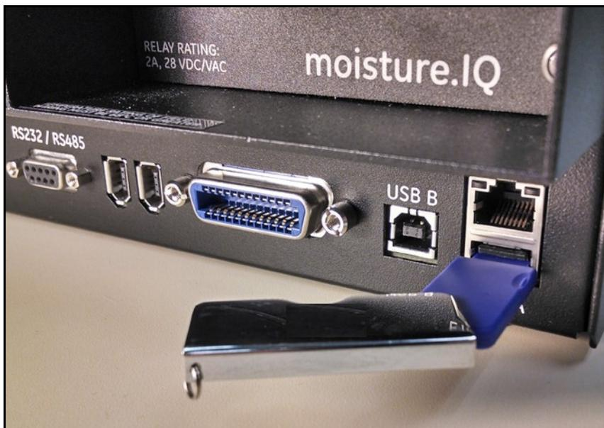
Рис. 84: Подключение флеш-накопителя USB к разъему в задней части корпуса
