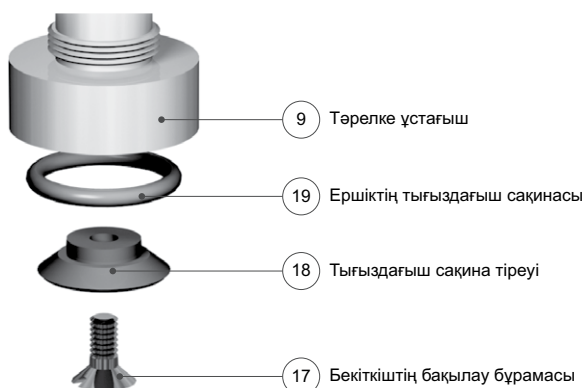
25-сурет. Тығыздағыш сақинасы бар ершік (D-J диафрагмалары)
