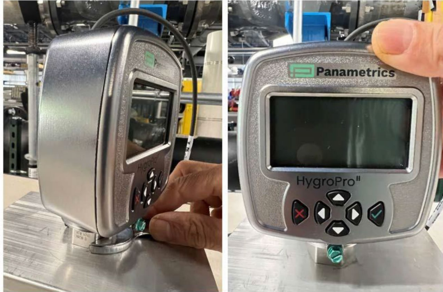
그림 6: HygroPro ® 설치 3단계 - 샘플 셀에 끼우기
