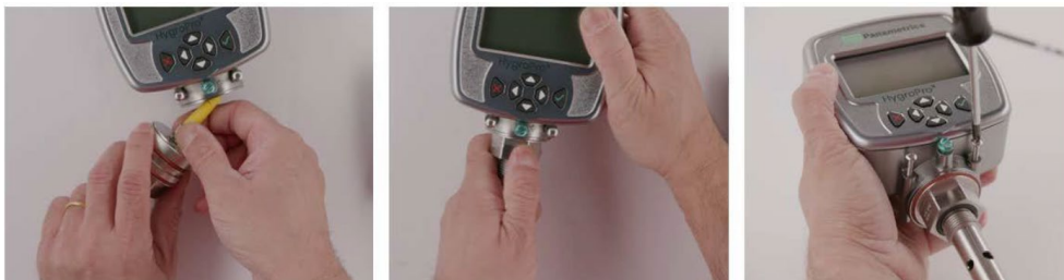
그림 19: 분리한 송신기에 Hygro ® RTE 브로프 다시 장착
