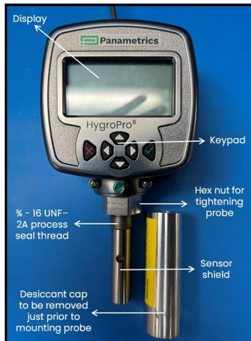
그림 3: 설치 시 중요한 HygroPro ® 부품들
