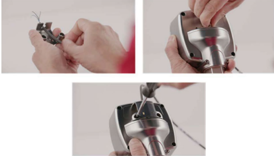
그림 4: HygroPro ® 설치 1단계 - 최초 배선
