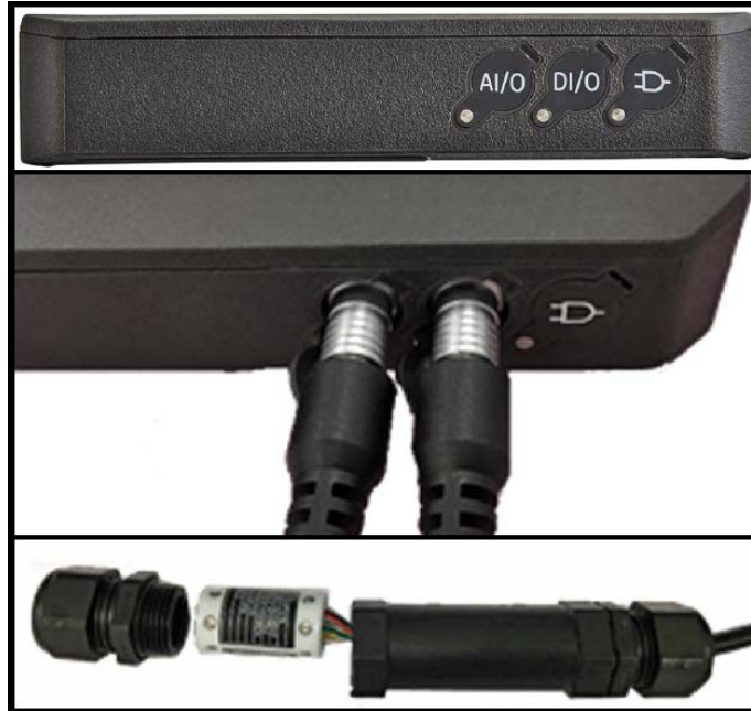
Şekil 46: Aktarıcı I/O Bağlantıları (Sağ Taraf)
