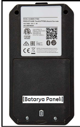
Şekil 50: Batarya Paneli Konumu
