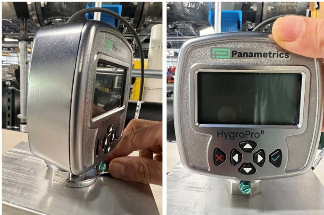
図6: ハイグロプロ II インストールステップ3-インストールサンプルセル
