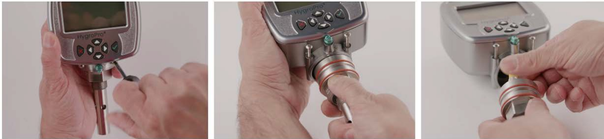
図17:送信機からハイグロ II RTEプローブを取り除くステップ
