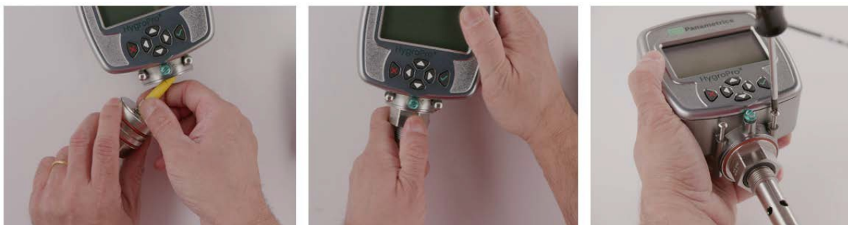
図19: 取り外した送信機にHygroII RTEプローブを再装着する
