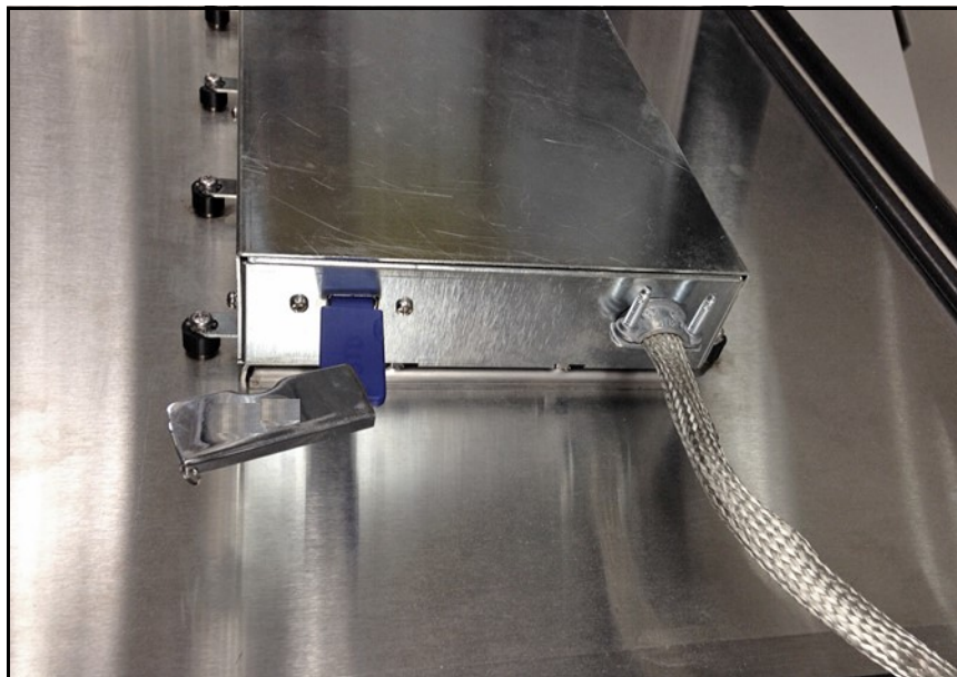
Figura 92: Unidade Flash USB conectada no chassi dentro da porta
