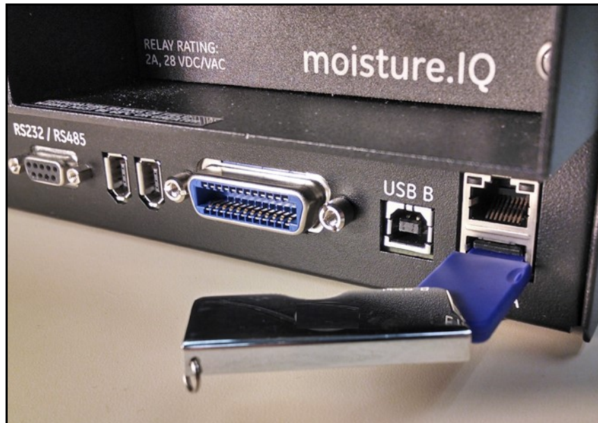
Figura 91: Unidade Flash USB conectada na parte posterior do chassi
