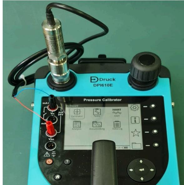
Verwenden Sie die entsprechenden Adapterverschraubungen, wenn das Gewinde des Druckanschlusses nicht mit dem des Schnellkupplungs für den DPI610E Test Port identisch ist. Die Adapteranschlüsse müssen für 35 barg ausgelegt sein. Gehen Sie wie folgt vor Abschnitt 2.1.5, „So schließen Sie das zu testende Gerät an“, auf Seite 20 , um den ADROIT-Sensor an den Testport anzuschließen.
