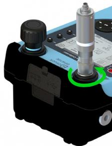
Um das zu prüfende Gerät an der Testöffnung oder dem Schmutzfänger zu befestigen, stecken Sie die Falle in das Gewinde des Drehkupplungs und drehen Sie dann den Drehsteckverbinder vollständig gegen den Uhrzeigersinn, bis er handfest ist.
