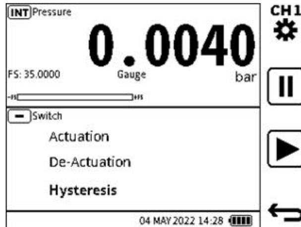
Der **Bildschirm des Kalibrators** wird mit den Daten des **Switch-Tests** eingestellt. Die druckbezogene Funktion ist auf CH1 eingestellt, während sich die Daten des **Schalttests im Fenster CH2** befinden.
