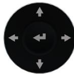
Das Navigationspad verfügt über die Tasten "Auf", "Ab", "Links", "Rechts" und "Enter", mit denen Sie sich schnell und einfach durch die Benutzeroberfläche bewegen können.
