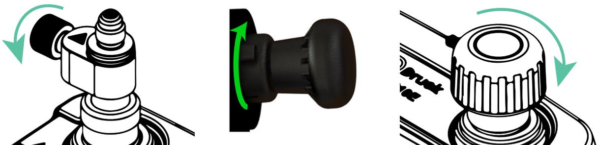
3. Stellen Sie sicher, dass das Ablassventil geschlossen ist (drehen Sie das Ventil vollständig im Uhrzeigersinn).
