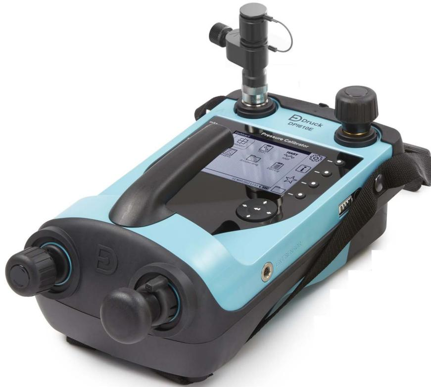
Das DPI610E-A ist eine pneumatische Variante des DPI610E Instruments für den Einsatz in der Luft- und Raumfahrtindustrie. Der Dashboard-Bildschirm verfügt über die zusätzliche Option Luftfahrt (Aero). Alle anderen Funktionen und Aufgaben sind die gleichen wie bei den anderen DPI610E Instrumenten.
