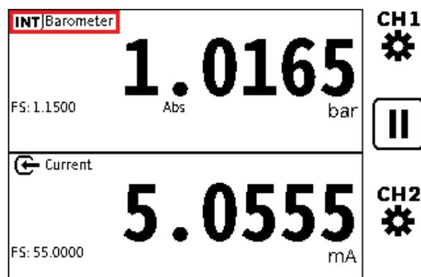
5. Stellen Sie sicher, dass die **Barometer-Funktion** im gewünschten Kanalfenster korrekt eingestellt ist.
