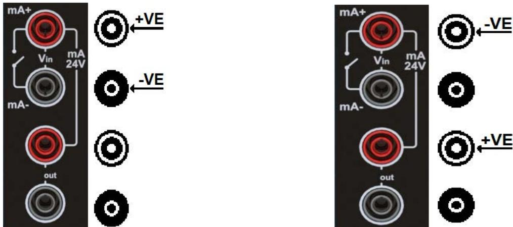
1. Verwenden Sie das Diagramm auf der linken Seite, um die notwendigen Verbindungen zur Stromquelle herzustellen. Dies ist erforderlich, wenn das interne 10-V/24-V-Netzteil nicht verwendet wird (wenn die Option Aus in Schritt 4 ausgewählt wurde). Verwenden Sie das Diagramm auf der rechten Seite, um die notwendigen Anschlüsse an die interne 10 V oder 24 V Versorgung herzustellen. Dies ist die Quelle der Stromversorgung.
