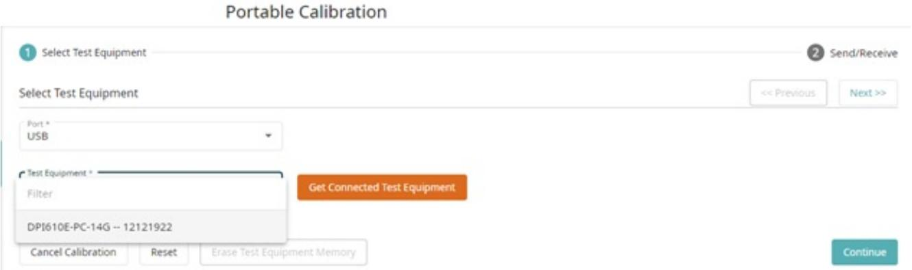
**Hinweis:** Wenn beim Herstellen einer Verbindung mit dem DPI610E Fehler auftreten, stellen Sie sicher, dass der DPI610E angeschlossen ist und sich im VCP-Modus (Virtual Communications Port) befindet. Wenn der Druck Comms Server nicht installiert und in Betrieb ist, kann die Verbindung nicht hergestellt werden.
