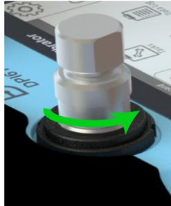
1. Stellen Sie sicher, dass der Blindstopfen den Testanschluss abdichtet. Um den Blindstopfen anzubringen, stecken Sie den Stecker in das Gewinde des Drehsteckverbinders, halten Sie ihn fest und drehen Sie den Drehstecker dann vollständig gegen den Uhrzeigersinn, bis er handfest ist.
