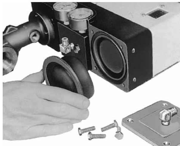
Figure 17 - Remplacement de la membrane
