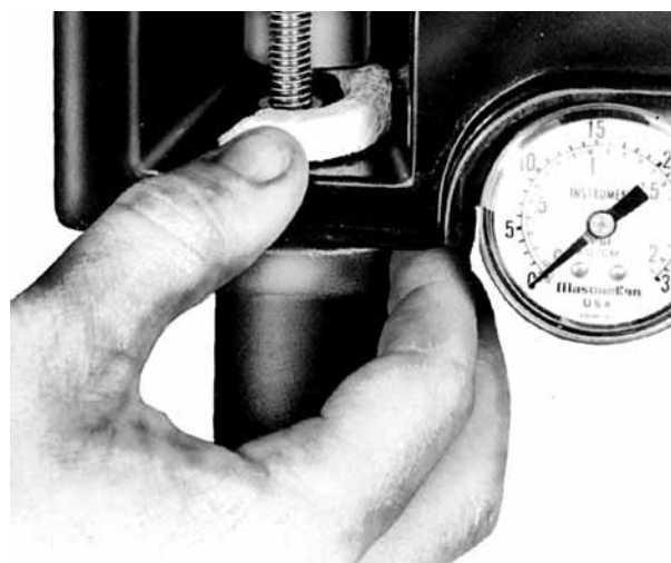
Figure 18 - Ajout d'une bague de garniture
