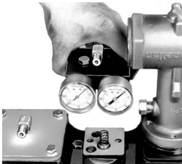
Figure 22 - Ensemble positionneur Remarque l'orientation du positionneur (147) et du joint (146)
