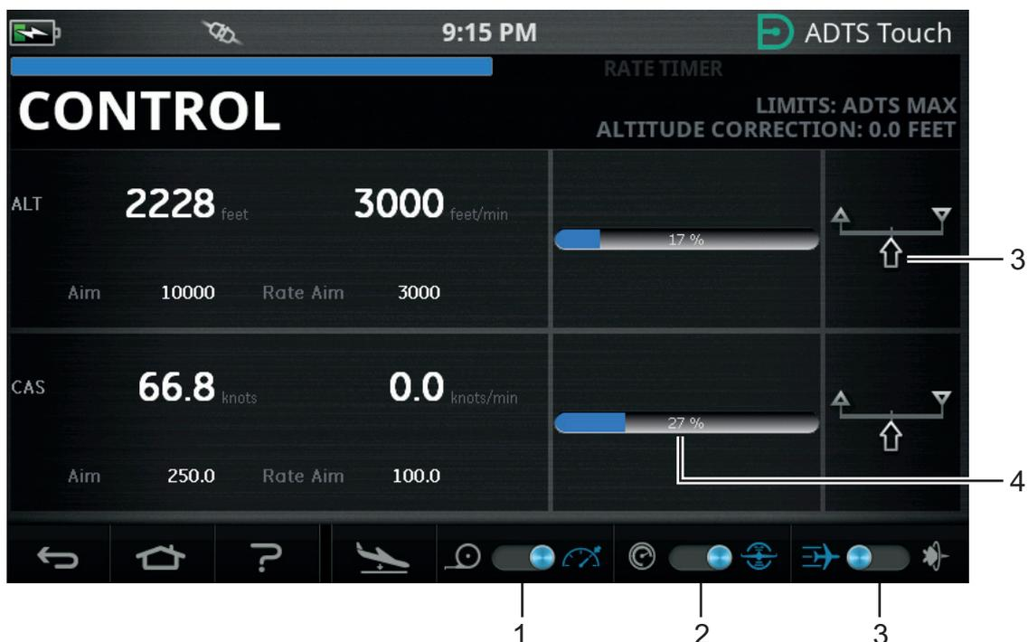
Figure 3-7 : Mode de contrôle – Monocanal
