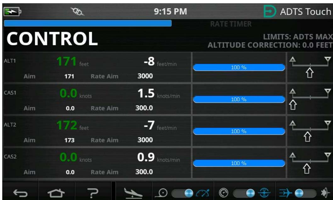
Figure 3-8 : Mode de contrôle – Multicanal
