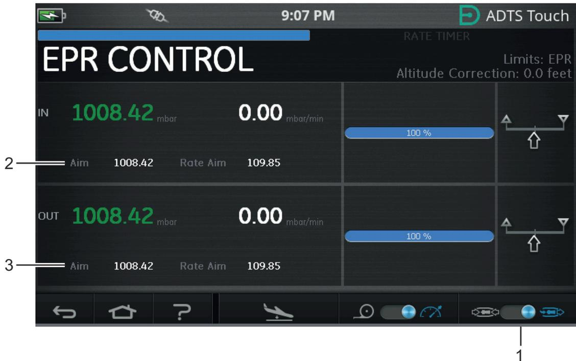
**Figure 3-33 : Écran de contrôle d'EPR (méthode 2)**
