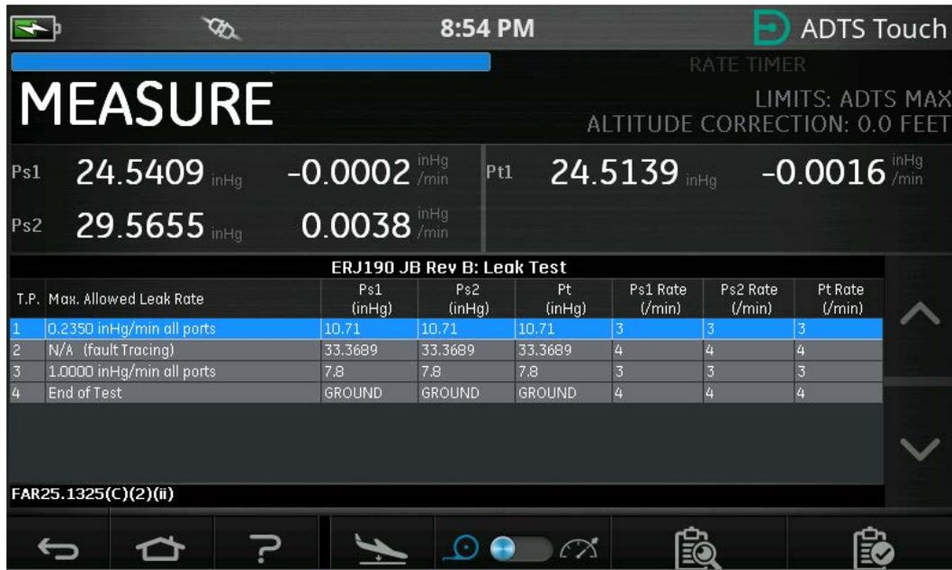
Figure 3-49 : Séquence de test en mode de mesure
