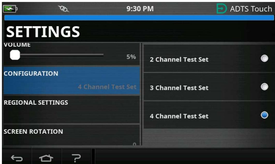
**Figure 3-31 : Menu des réglages pour désactiver les canaux**
