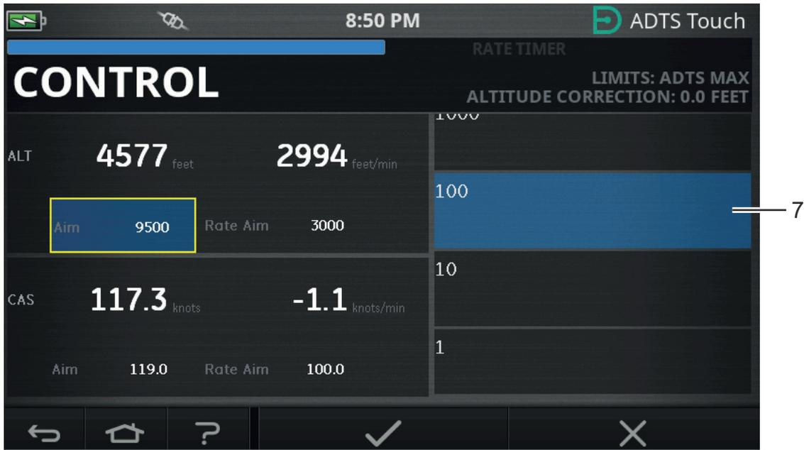
**Figure 3-10 : Sélection du coefficient d'augmentation/de diminution**
