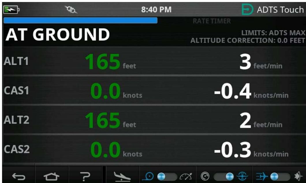
Figure 3-27 : Retour à la pression au sol achevé – Multicanal
