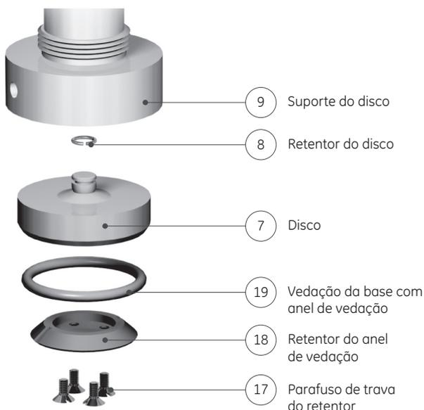
**Figura 26: Base do anel de vedação (Orifícios K - W)**
