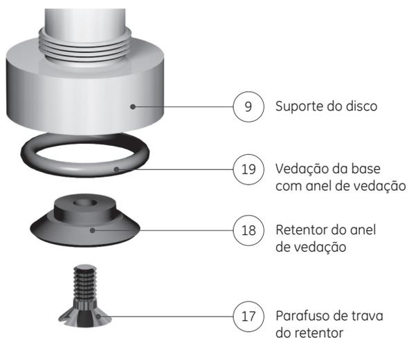
**Figura 25: Base do anel de vedação (Orifícios D-J)**
