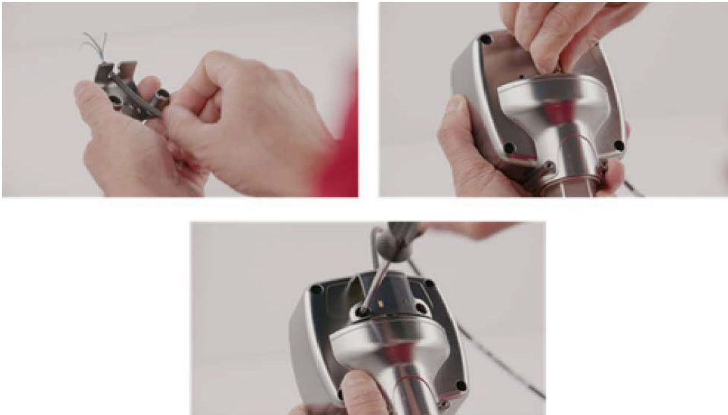
Abbildung 4: HygroPro II Installationsschritt 1 – Erstverdrahtung
