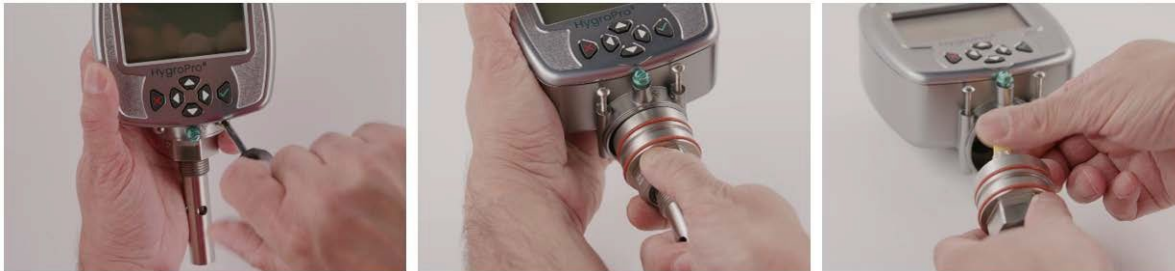
Abbildung 17: Schrittweiser Ausbau der Hygro II RTE-Sensorelements aus dem Transmitter
