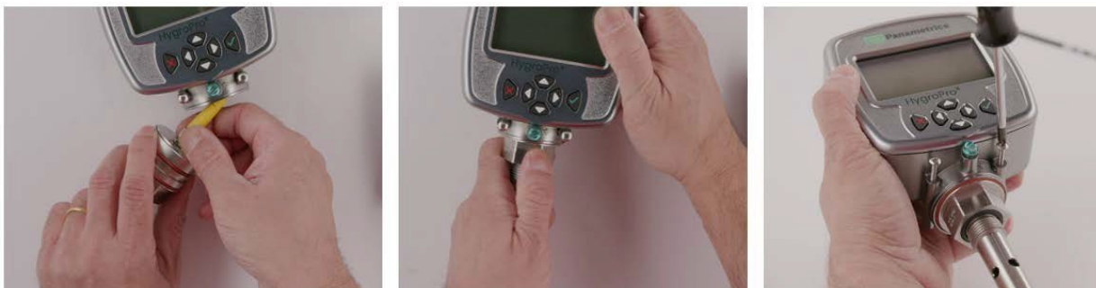
Abbildung 19: Einbau des Hygro II RTE-Sensorelement in den demontierten Transmitter
