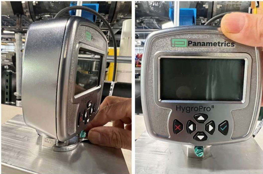
Abbildung 6: HygroPro II Installationsschritt 3 – Installation in der Messkammer
