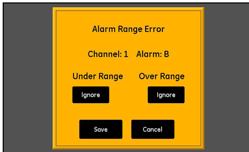
Figure 49: Écran de configuration de l'erreur plage - Réponse de l'alarme
