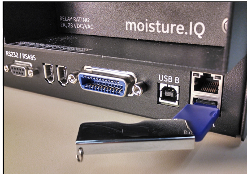
Figure 91: Clé USB insérée en face arrière du châssis
