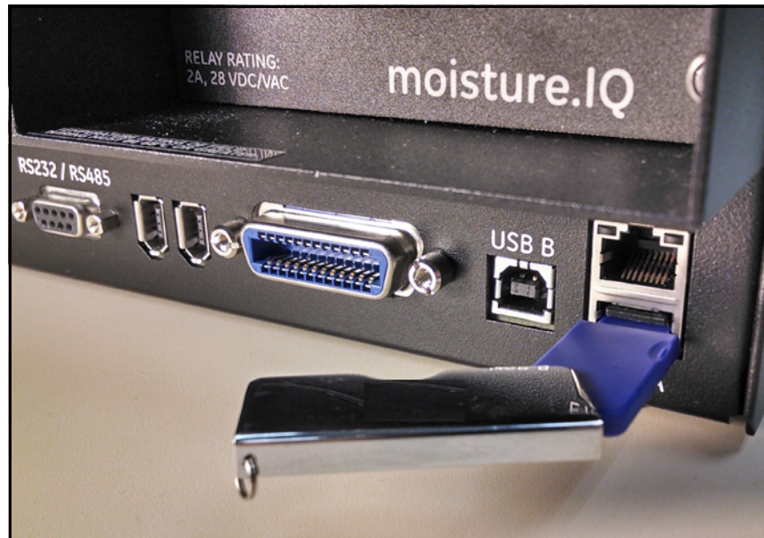
Figure 84: Clé USB insérée en face arrière du châssis
