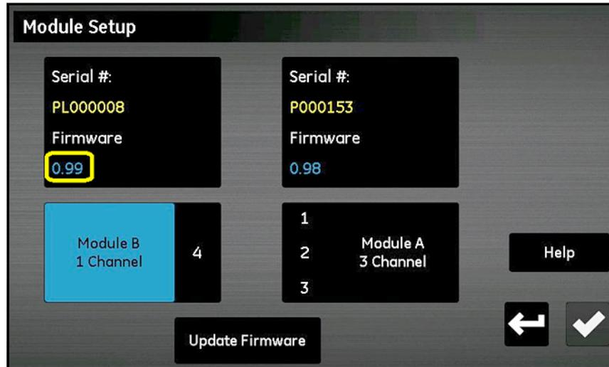
Figure 99: Module avec micrologiciel mis à jour
