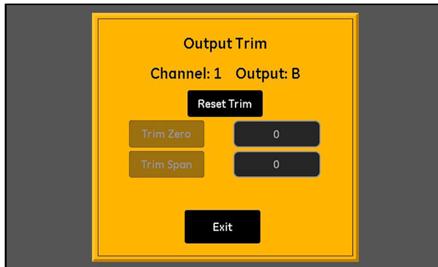
Figure 45: Écran Ajuster sortie
