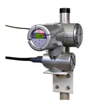
I. Dezentrale Prüfkopfverdrahtung (nur dezentrale Montage). Um elektrische Anschlüsse vorzunehmen, entfernen Sie die Leiterplatte vom Gehäuse. Lösen Sie dazu zuerst die Schrauben und drehen Sie die Leiterplatte gegen den Uhrzeigersinn. Führen Sie die Kabel jeweils einzeln durch eine Kabeldurchführung an der Seite des Gehäuses und schließen Sie sie an die vorgesehenen Anschlüsse der Leiterplatte an.
