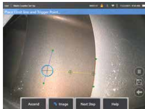
図3bに示す。進入線と出口線間のリミットラインの調整
