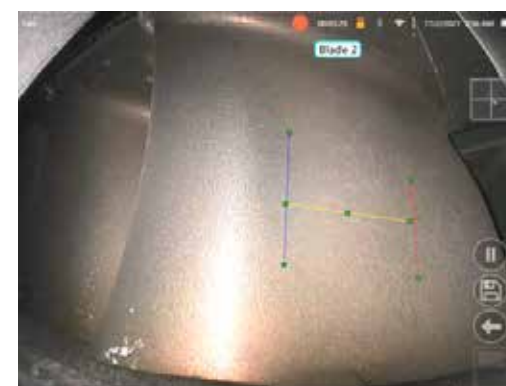
図9c.元のトラッキング領域を示すブレードカウンターアクティブサブメニュー。
