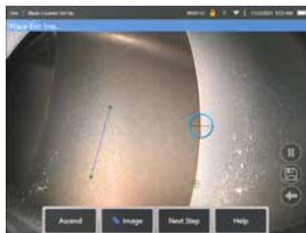
図2b.出口線をエアロfoilエッジに調整
