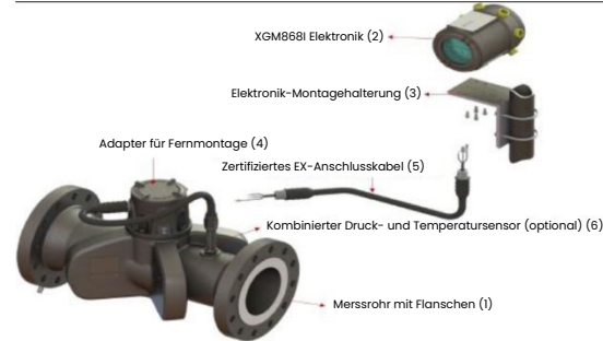
Abbildung 2: Fernmontage des PanaFlow Z1G/Z2G Transmitters
