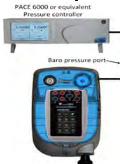
Figure 4-4 : Configuration de l'étalonnage barométrique
