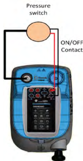
Figure 4-1 : Configuration du test de commutation
