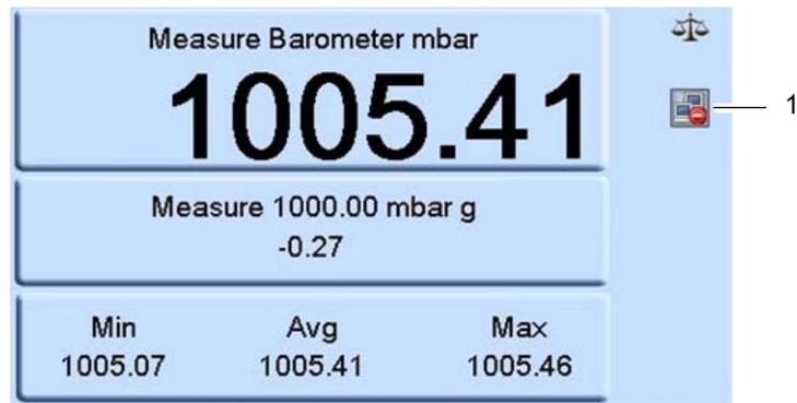
Функциональная область Min/Avg/Max выполняется по показаниям, выбранным для отображения на верхнем экране.
