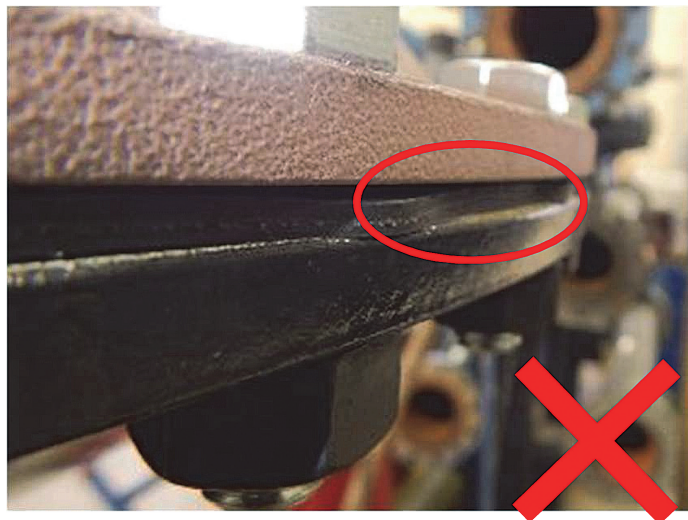
Figure 6 - Membrane tirée vers l'intérieur
