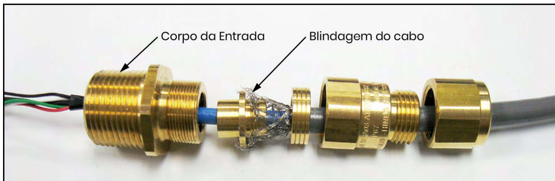
Figura 90: Montagem Adequada da Sobreposta do Cabo (Panametrics p/n 419-217)
