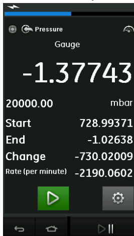
Figure 2-24 : Exemple de test d'étanchéité
