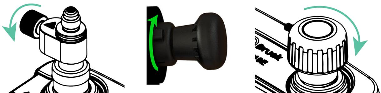
3. レットダウンバルブが閉じていることを確認します (バルブを時計回りに完全に回します)。
