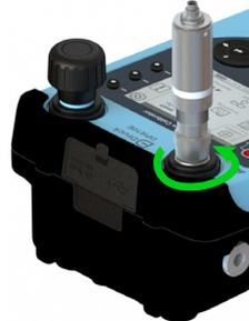
テスト対象のデバイスをテストポートまたはダートトラップに取り付けるには、トラップをスイベルコネクタのネジ山に入れてから、スイベルコネクタを反時計回りに完全に回して手で締めます。
