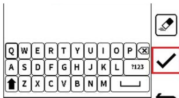
10. デフォルトの結果ファイル名は、機器のテストの日付と時間 (HH:MM:SS) になります。これは、必要に応じて名前を変更できます。**Tick** ソフトキーを選択して結果ファイル名を確認し、保存操作を完了します。
