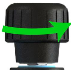
システムを大気圧に通気するには、センサーの読み取り値がゼロ (ゲージセンサー) または 1 バール (絶対センサー) になるまで、圧力解放バルブをゆっくりと反時計回りに完全に回します。
