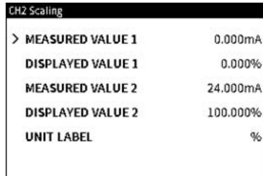
3. **スケーリング** エリアをタップするか、ナビゲーションパッドボタンを使用してエリアを選択します。画面には、選択したチャンネルの **スケーリング** 画面が表示されます。
