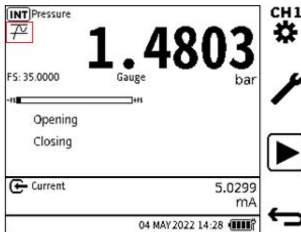
3. キャリブレーター画面は **リリースバルブ** テストデータで設定されます。**CH1** ウィンドウは自動的に大きくなり、テストデータが表示されます。
