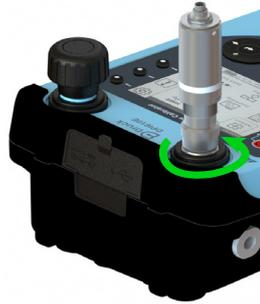
5. テスト対象のデバイスをテストポートまたはダートトラップに取り付けるには、デバイスをソケットに保持し、コネクタの基部にあるスィベルコネクタを反時計回りに完全に回して、手で締めます。テスト対象のデバイスにオスの G 3/8 Quickfit アダプタースレッドがあることを確認するか、定格 35 bar の適切なアダプターを使用してください。ご不明な点がございましたら、サービス & サポートまでお問い合わせください - バックページをご覧ください。
