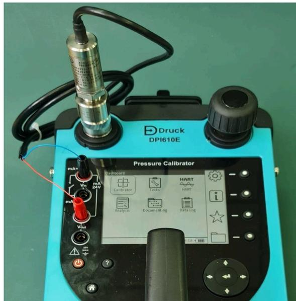
圧力コネクタのねじ山が DPI610E テストポートクイックフィットコネクタと同じでない場合は、該当するアダプタ継手を使用してください。アダプターフィッティングの定格は 35 barg である必要があります。セクション 2.1.5 「テスト対象のデバイスを接続するには」(23 ページ) の手順を使用して、ADROIT センサーをテストポートに取り付けます。
