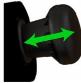
19. テストするデバイスを接続した後、ボリュームアジャスターを反時計回りに約半分の回転数で回転させ、ステップ 17f の最初の部分で行い、同時にプライミングポンプをゆっくりと押して流体圧力を 10 ~ 15 バールに保ちます、これはユーザーがステップ 17f を使用してデバイスを接続した場合にのみ適用されます。それ以外の場合は、プライミングポンプを使用して、流体圧力を 10 ~ 15 バールに保ちます。
