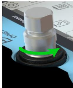
1. ブランキングプラグがテストポートを密閉していることを確認してください。ブランキングプラグを取り付けるには、プラグをスイベルコネクタのネジ山に入れ、所定の位置に保持してから、スイベルコネクタを反時計回りに完全に回して手で締めます。
