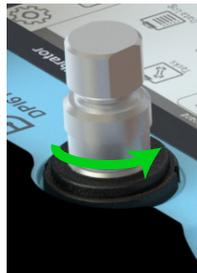
ブランキングプラグはテストポートを密閉します。テストポートを使用しないときは、ブランキングプラグを取り付けてください。これにより、ポートに不要な材料が入らなくなります。ブランキングプラグをテストポートに取り付けるには、プラグをスイベルコネクタに差し込み、所定の位置に保持します。スイベルコネクタを反時計回りに完全に回して、手で締めます。
