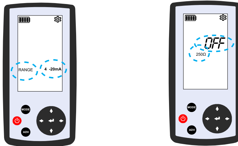
Abbildung 2-6: Einstellungen - Bereich und 250 Ohm Widerstand
