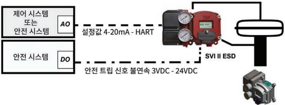
그림 14 - 아날로그 개별 안전 수요(A/ DSD) 구성
