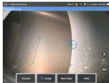
2b. ábra A kilépési vonal beállítása az aerofoil élére
