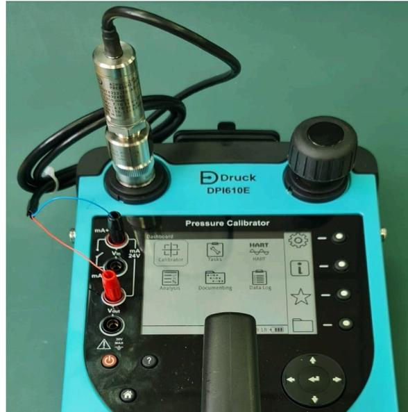
Utilisez les raccords d'adaptateur appropriés si le filetage du connecteur de pression n'est pas le même que celui du connecteur à montage rapide du port de test DPI610E. Les raccords de l'adaptateur doivent être évalués à 35 barg. Utilisez la procédure décrite pour Section 2.1.5, « Pour fixer l'appareil testé, » page 20 pour fixer le capteur ADROIT au port de test.
