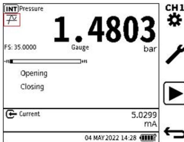
3. L'écran de l'étalonneur sera réglé avec les données de test de la **soupape de décharge**. La **fenêtre CH1** s'agrandit automatiquement pour afficher les données de test.
