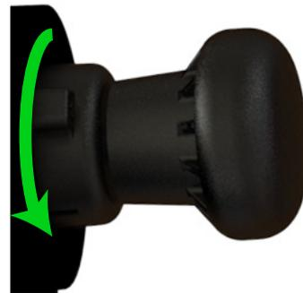
2. Assurez-vous que la vanne d'éjection est fermée. Fermez également la soupape de décharge (tournez les deux vannes à fond dans le sens des aiguilles d'une montre).
