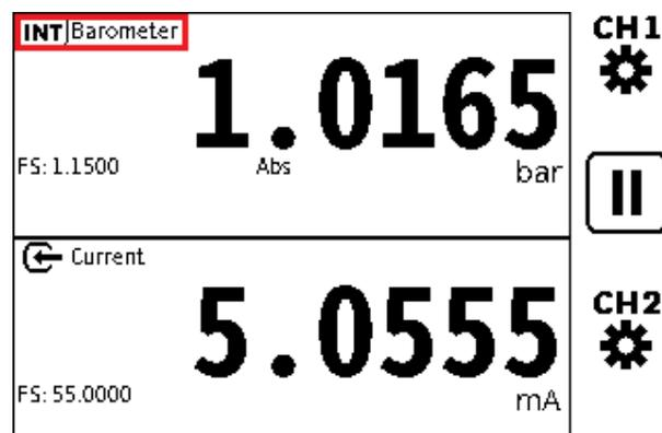
5. Assurez-vous que la **fonction Baromètre** est correctement réglée dans la fenêtre du canal souhaité.
