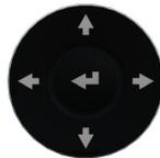
Le pavé de navigation dispose des boutons Haut, Bas, Gauche, Droite et **Entrée pour un déplacement rapide et facile dans l'interface utilisateur.**
