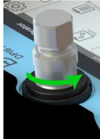
Un bouchon d'obturation scelle l'orifice de test. Fixez le bouchon d'obturation lorsque le port de test n'est pas utilisé. Cela permet de garder le port exempt de matériaux indésirables.
