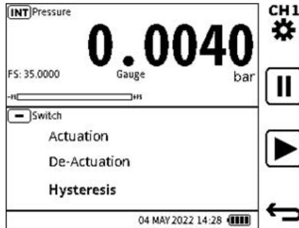
L'écran **du calibre** sera configuré avec les données de test de **commutation**. La **fonction liée à la pression est réglée sur CH1** tandis que les données de test de **commutation se trouvent dans la fenêtre CH2**.
