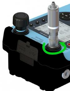
Pour fixer l'appareil testé au port de test ou au piège à saleté, placez le piège dans le filetage du connecteur pivotant, puis tournez le connecteur pivotant à fond dans le sens inverse des aiguilles d'une montre jusqu'à ce qu'il soit serré à la main.
