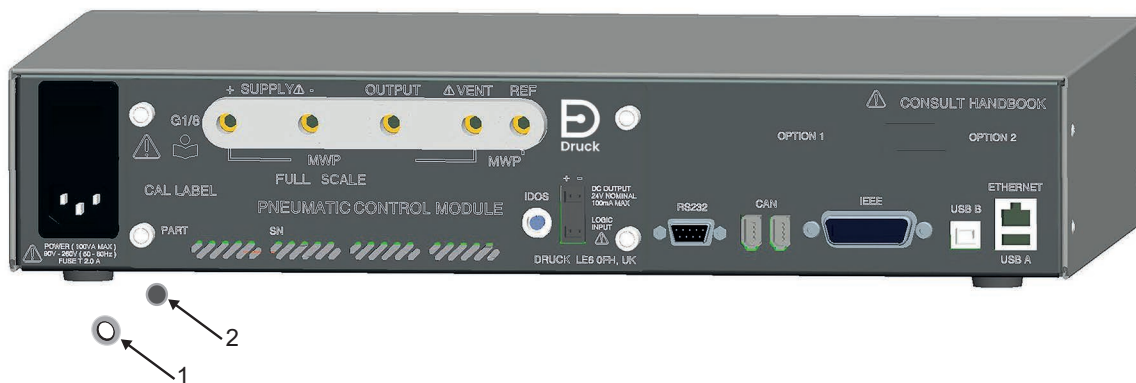
Рисунок 4-2: Замена фильтра модуля управления давлением
