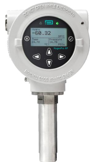
HygroProXP水分トランスミッターは、最も厳しい危険エリアでの用途に対応するために設計された、コンパクトなトランスミッターです。IP66/Type4X規格の防爆 筐体に収められたバックライト付きディスプレイと6ボタンの キーパッドを備えています。この ディスプレイとキーパッドにより、プローブ測定、アナログおよびデジタル (HART) 出力、その他の 機能や診断の設定を簡単に実施できます。また、HygroProXPは HARTプロトコルインターフェイスを介した マルチドロップネットワーク機能を備えており、複数のユニットを 同一ネットワーク上に接続することが可能です。
