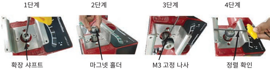
그림 4 - 회전 밸브에 대한 키트 어셈블리 장착 절차
