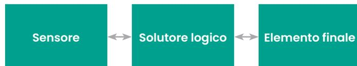
Un sistema SIS riporta automaticamente un processo industriale ad una condizione di sicurezza quando le condizioni specificate sono violate. Pertanto, questo sistema consente a un processo di proseguire in maniera sicura se le condizioni specificate lo consentono.
