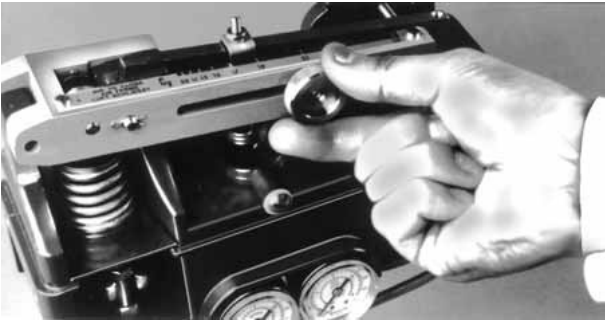
Kuva 4 – Säädettävän C V -arvon VariPak 28002 -venttiilin säätäminen kullekin tulppa-/istukkarengasyhdistelmälle
