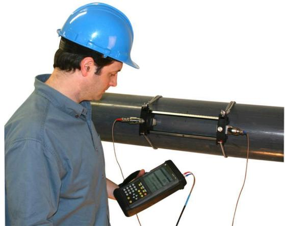
Anwender eines tragbaren Durchflussmessers
