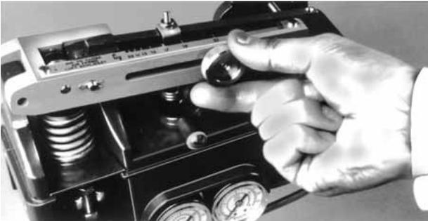
Figura 4 - Ajuste del C<sub>v</sub> de la válvula VariPak 28002 para cada combinación de tapón/anillo de asiento
