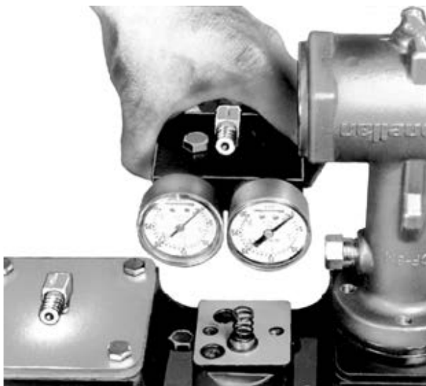
Figura 22 - Ensamblaje del posicionador Registre cómo están orientados el posicionador (147) y la junta (146)
