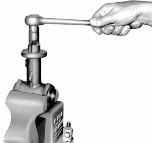
Figura 19 - Ajuste del retenedor del anillo del asiento (4)
