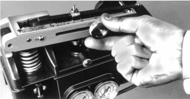
Figura 4 - Ajuste del C_v de la válvula VariPak 28002 para cada combinación de tapón/anillo de asiento
