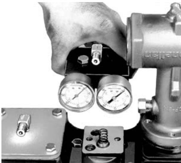
**Figura 22 - Ensamblaje del posicionador**
