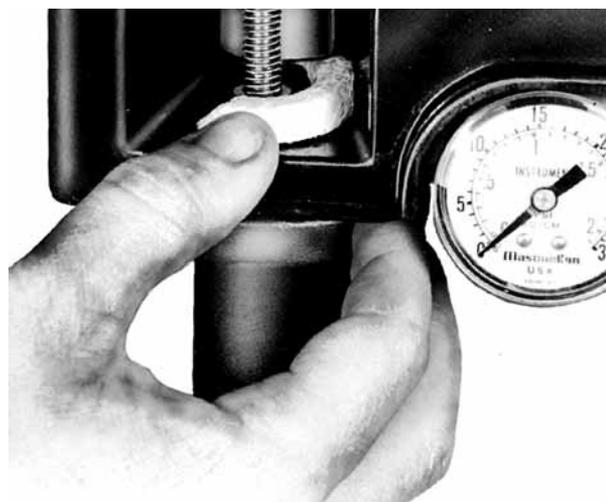
Figura 18 - Agregar de un anillo de empaque
