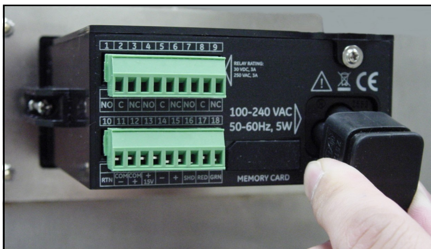
Figure 38: Branchement du câble d'alimentation CA
