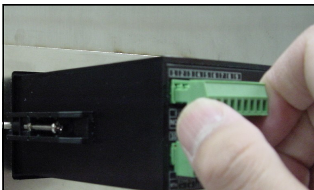
Figure 37: Retrait du connecteur supérieur
