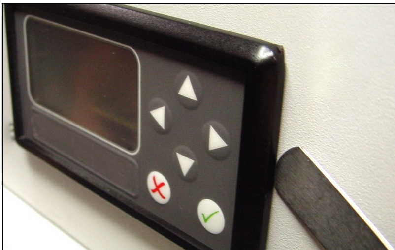
Figure 15: Vérification de la compression du joint
