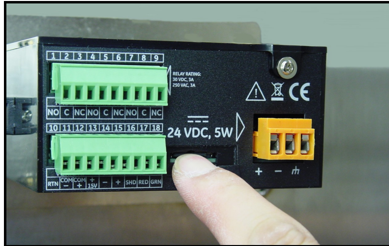
Figure 53: Enfacement de la carte MicroSD
