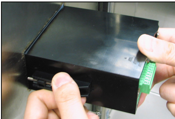
Figure 13: Blocage des supports de fixation en place
