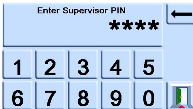
**Nota:** El PIN de supervisor de fábrica es 0268. Si el PIN de supervisor se ha modificado localmente, asegúrese de guardarlo en un lugar seguro. Si pierde el nuevo PIN, solo podrá restablecerlo en un centro de servicio técnico de Druck.
