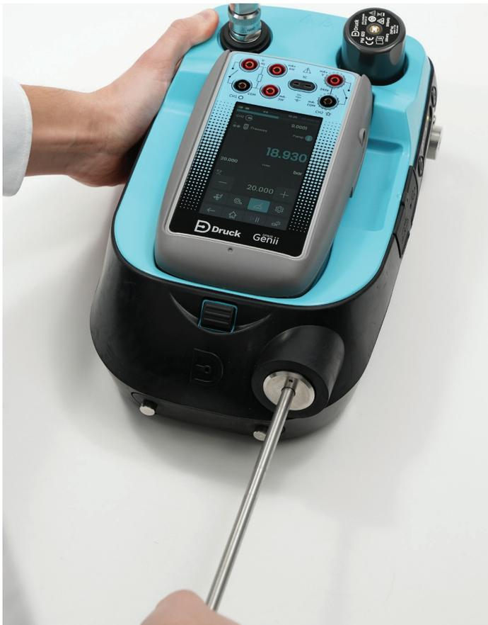
Una vez situados en el punto de ajuste, el PV624 genera y controla automáticamente la presión para combatir el efecto adiabático o de fugas menores.
