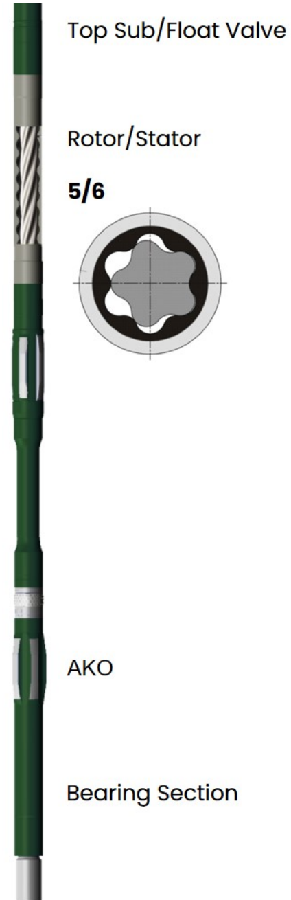
5 1 / 8 -in. DuraMax D025-5030C Motor
