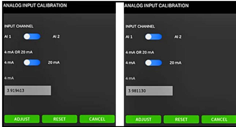
Рис. 112: Значение входов 4 мА до (слева) и после (справа) калибровки
