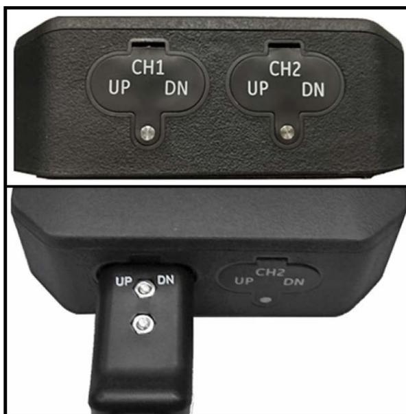
Рис. 45: Подключения измерительного преобразователя (снизу)
