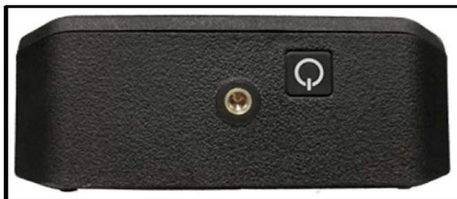
Рис. 51: Кнопка питания передатчика (сверху)
