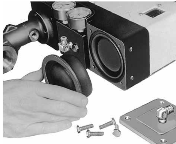
Figur 17 - Udskiftning af membran
