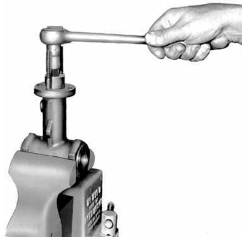
Figur 19 - Tilspænding af ringholderen (4)
