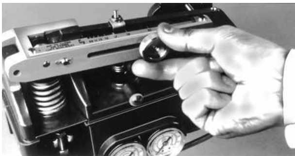
Figur 4 - justering af C_v af Varipak 28002-ventil til hver prop- og ringkombination
