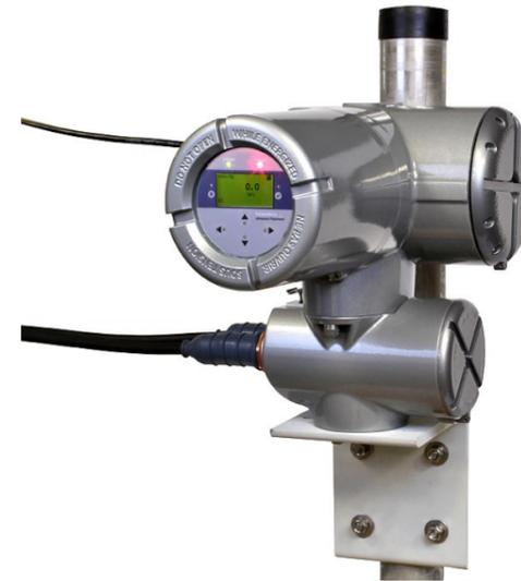
**4. Fiação de transdutor remoto (montagem remota apenas).** Para fazer conexões elétricas, remova a placa terminal do gabinete soltando primeiro os parafusos e girando o contador da placa terminal em sentido horário. Alimente cada cabo através de um orifício do conduto na lateral do compartimento e conecte-o na conexão apropriada na placa terminal.
