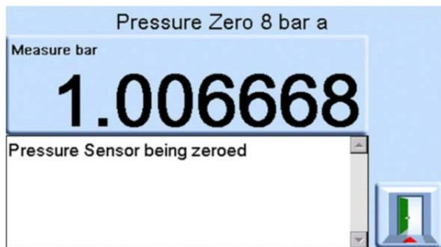
2. 指示器现在将对压力读数进行采样并自动将传感器归零。
