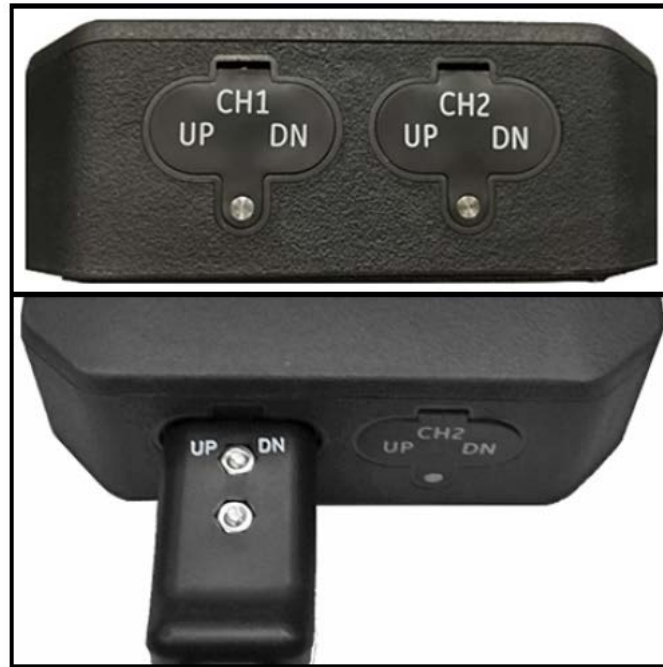
Figura 45: Conexiones del transductor (parte inferior)
