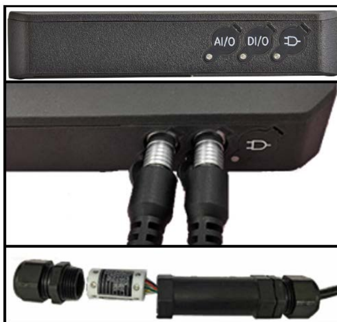
Figura 46: Conexiones de E/S del transmisor (lado derecho)
