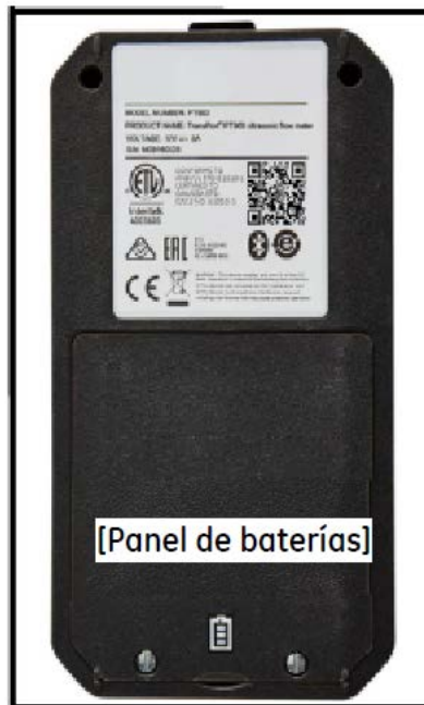
Figura 50: Ubicación del panel de las baterías
