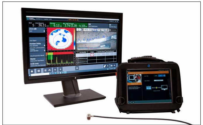
对于点焊缝检测, Krautkrämer SpotVision是简单且精确的相控阵解决方案。
