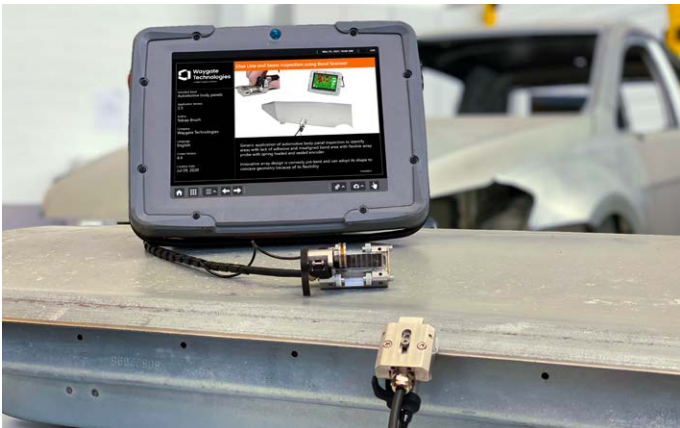
Krautkrämer Bond Scanner 可以对粘合部件进行快速且简便的测试。
