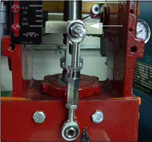
图 5 连接左侧杆端
